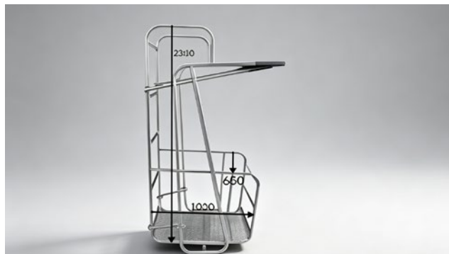
边梁负弯矩张拉吊篮
