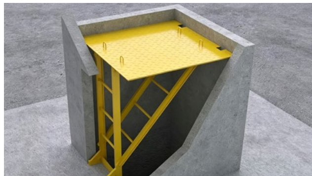
电梯井作业平台
