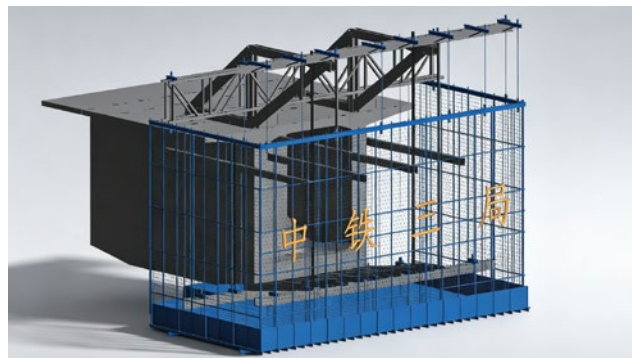
挂篮造桥机防护系统
