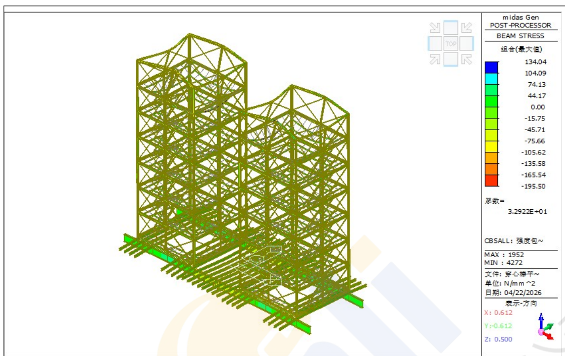
最大组合应力 195.50MPa（强度包络）
