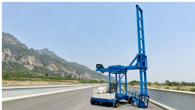
排水管施工台车
